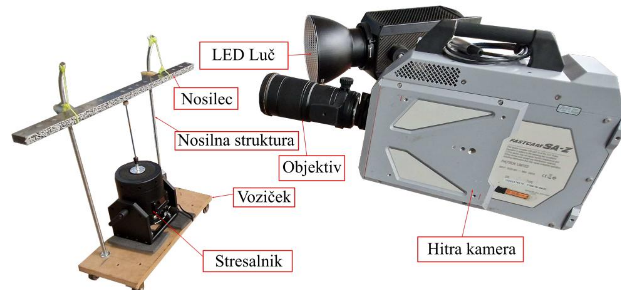
Slika 5: Eksperimentalna postavitve nosilca, vzbujanega preko elektrodinamskega stresalnika, in hitre kamere.
