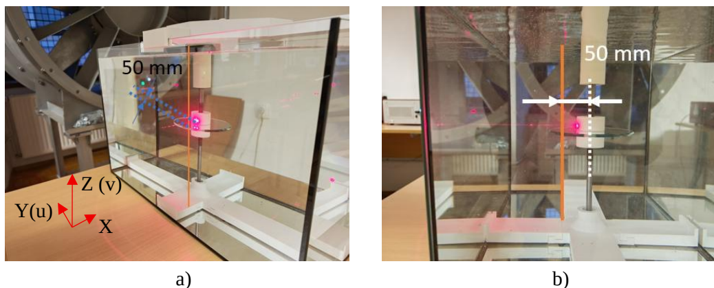
Slika 7: Prikazano mesto opravljanja meritev – hitrost je bila merjena v Z smeri (prikazano z oranžno črto), 50 mm od centra (prikazujeta sliki a) in b)). Slika a) prikazuje koordinatni sistem merilnega sestava. Merila se je u komponenta hitrosti, v smeri osi Y.
